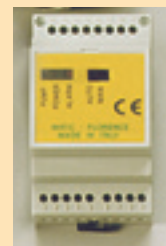
CENTRALINA DI COMANDO CON INGRESSO PER I 2 REGOLATORI DI LIVELLO E SINGOLA USCITA IN COMMUTAZIONE, FINO A 2HP 250V c.a. 50 HZ. PANEL WITH INPUT FOR 2 LEVEL REGULATORS AND SINGLE CHANGE OVER OUTPUT, UP TO 2HP 250V a.c. 50 HZ.
